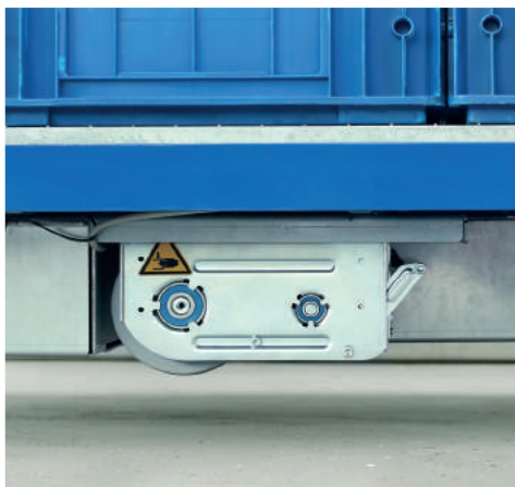
La posición "Standby" garantiza la movilidad libre del carro.
